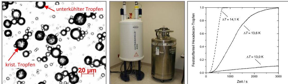
Abbildung 1: V.l.n.r.: Schmelzemulsion mit unterkühlten und kristallisierten Tropfen; NMR-Spektrometer zur Bestimmung des kristallinen Anteils in Emulsionen; zeitlicher Verlauf des kristallinen Schmelzetropfen-Anteils (=Kristallisationsrate) bei unterschiedlichen Unterkühlungen \Delta T ohne Scherung. Wie verändert sich dieser Anteil unter Scherung infolge von Kollision bzw. Partikel/Tropfenwechselwirkungen im Vergleich zu unbewegten Schmelzemulsionen?
